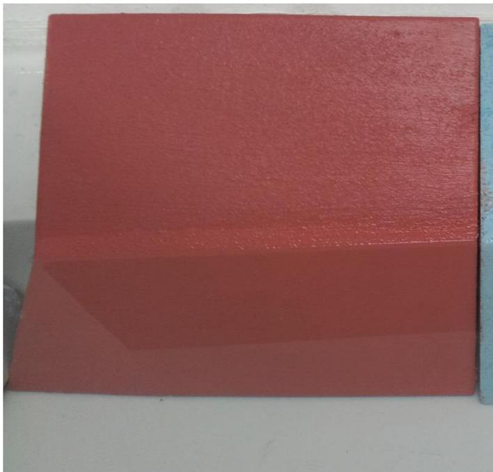
QUESTA PROVA SERVE A DETERMINARE LA RESISTENZA DI UN PRODOTTO IMPERMEABILIZZANTE A CONTATTO PROLUNGATO CON L'ACQUA.
